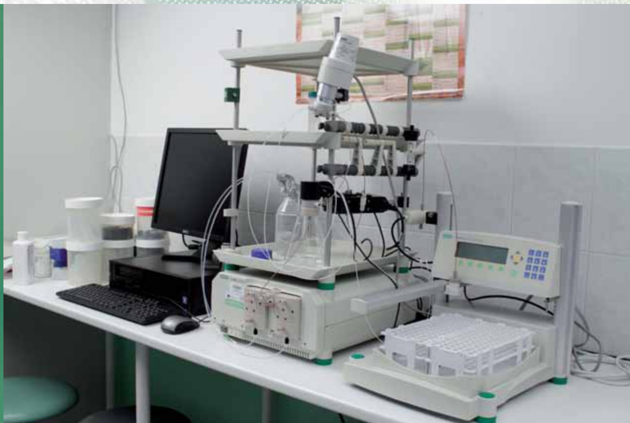
Kapalinový chromatografický systém pro separaci proteinů Liquid chromatography system for protein separation
